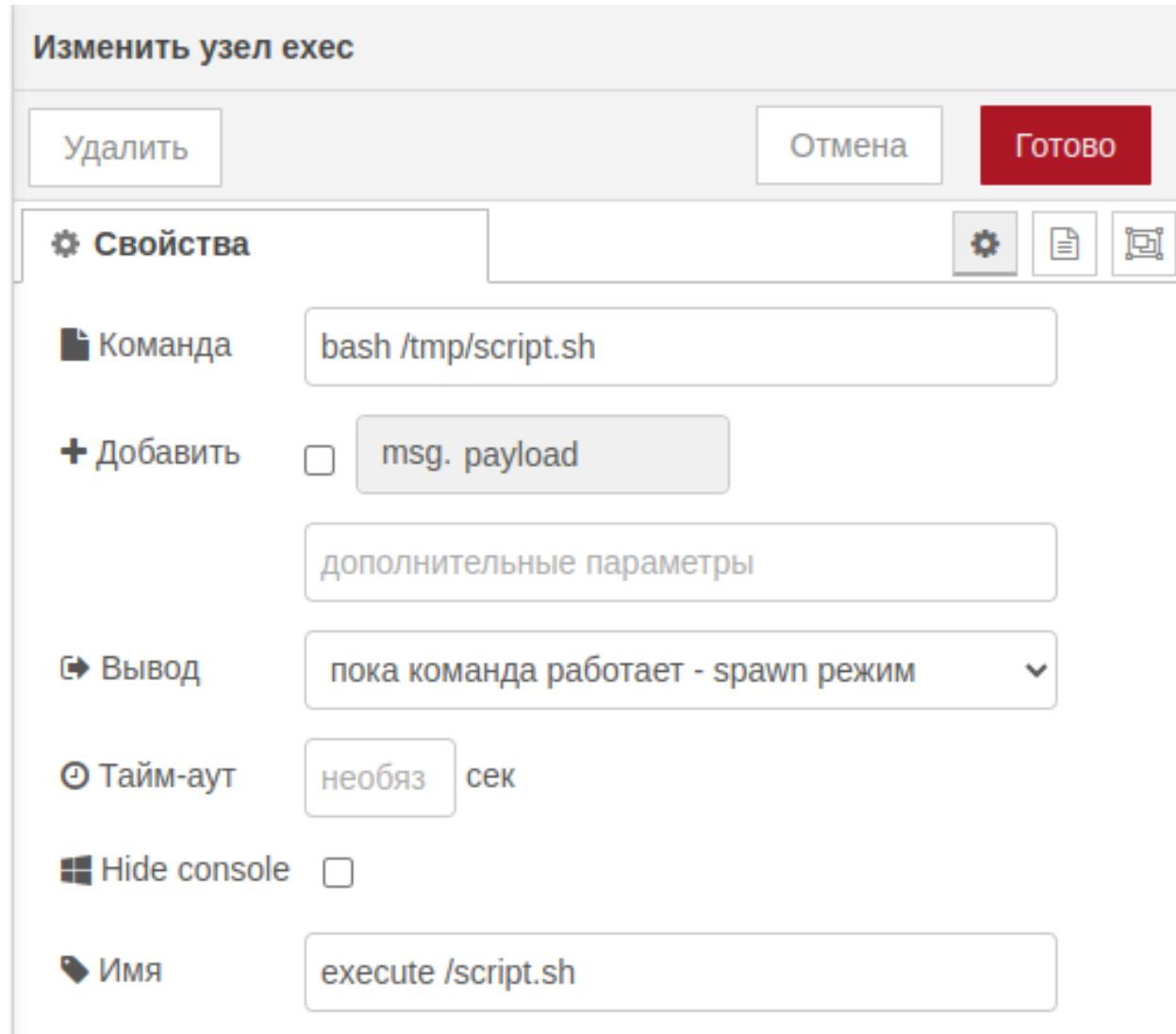
Рис. 4.55 Исполняем файл
