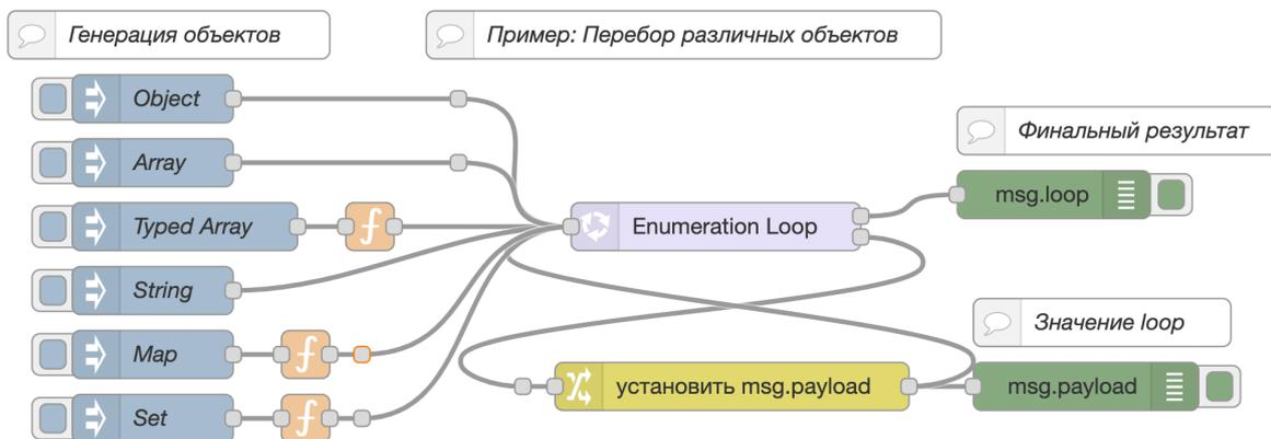
Рис. 4.56 Поток обработки входящего объекта по циклу
