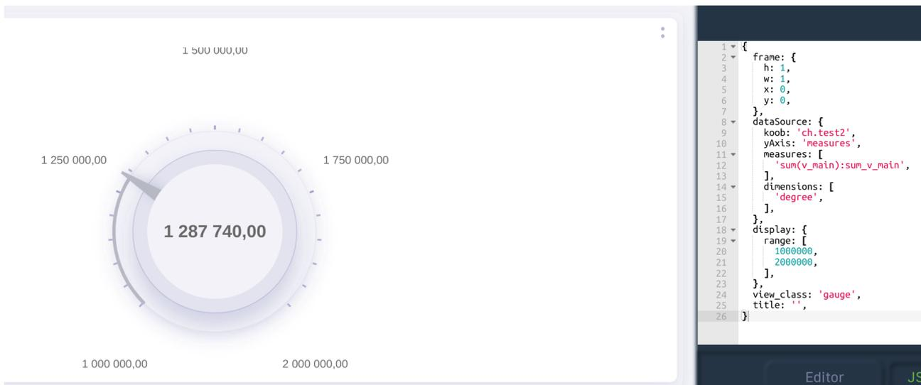
Рис. 2.31 Спидометра с указанным диапазоном в `range`
