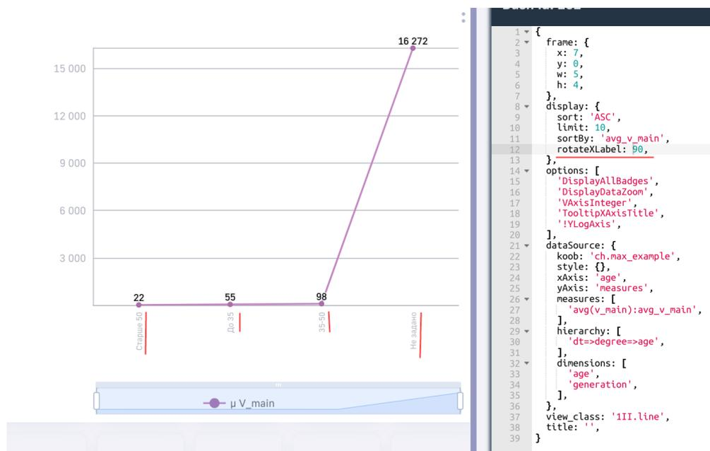
Рис. 2.22 Использование `rotateXLabel` для дэша “Линии”
